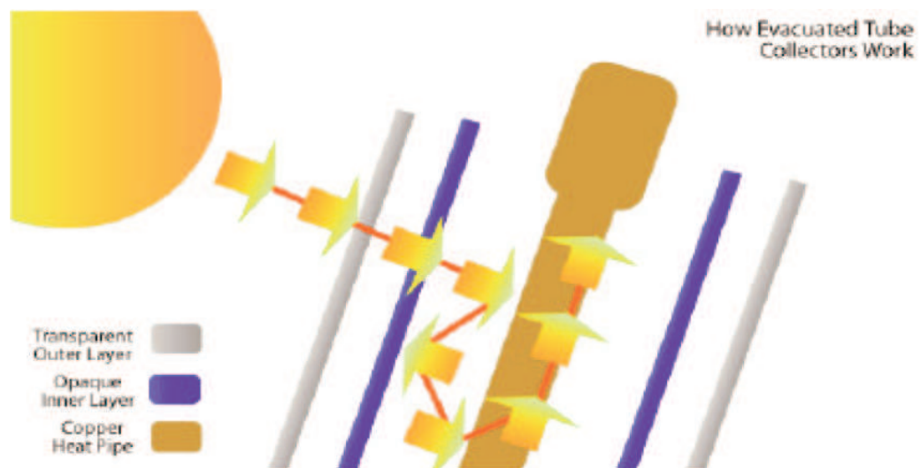
Figura 18: Funcionamento de uma bomba de calor de tubo a vácuo (Fonte: Sunmaxx)
